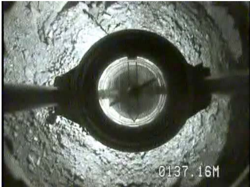
Figura 4.11 C-26 muestra el barreno obstruido a 137 metros
