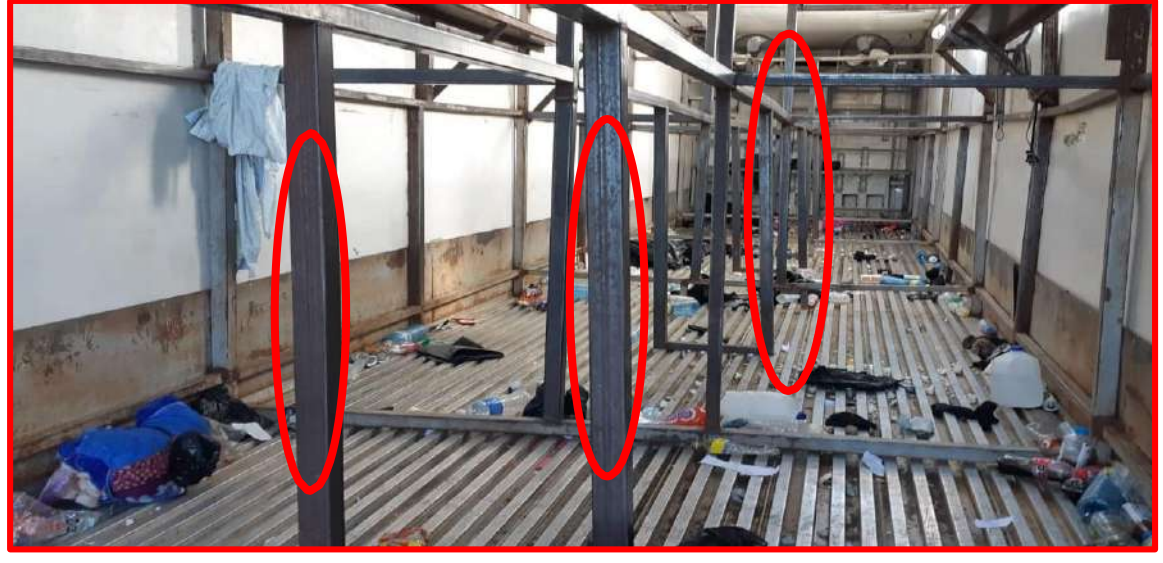
La caja refrigerada fue adaptada con hileras de ventiladores, una estructura tubular compleja y depósitos de agua.
