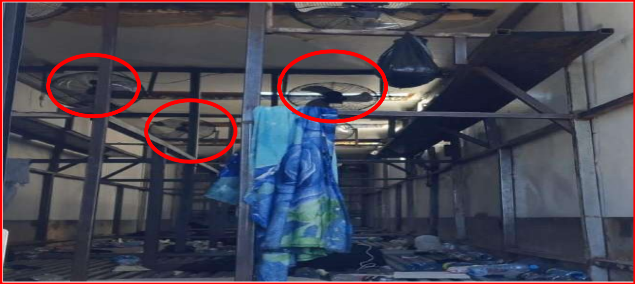
La caja refrigerada fue adaptada con hileras de ventiladores, una estructura tubular compleja y depósitos de agua.
